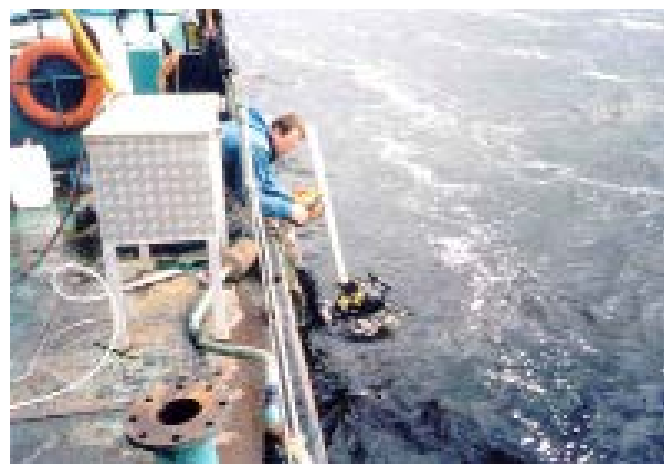
FOTO 1: BEMONSTERING VAN GRONDWATER VAN EEN BAGGERDEPOT IN EEN VOORMALIGE ZANDWINPUT (FOTO: DHV).
